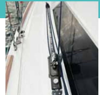
**Pack easy sail: Réglage du chariot de génois au cockpit** • Easy sail pack: genoa traveller trimming from cockpit • *Pack easy sail: Regolazione carrello genoa in pozzetto* • *Pack easy sail: Reglaje del carro escotero de genova en la bañera*
